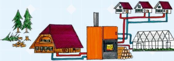
La chaleur produite par une chaudière à bois installée sur une exploitation agricole est acheminée par un réseau de conduites vers les différents utilisateurs sous forme d'eau surchauffée. Celle-ci est destinée à chauffer les habitations et l'eau sanitaire. Une fois sa chaleur transmise, cette eau retourne ensuite à l'installation thermique de la ferme et boucle ainsi son circuit.
